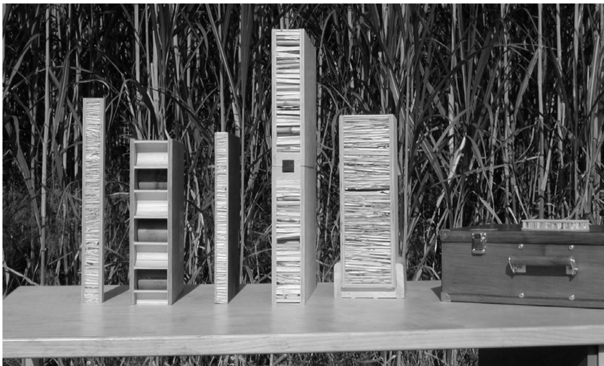
Abbildung 8: Aufbau verschiedener LNS-Elemente (MÖLLER, 2003)
